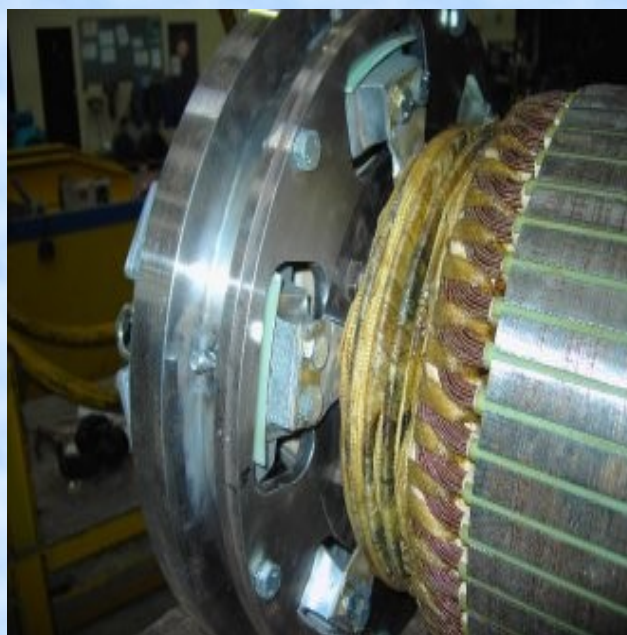
Rotor d'excitateur avec redresseur pour turboalternateur 3000 T/M
