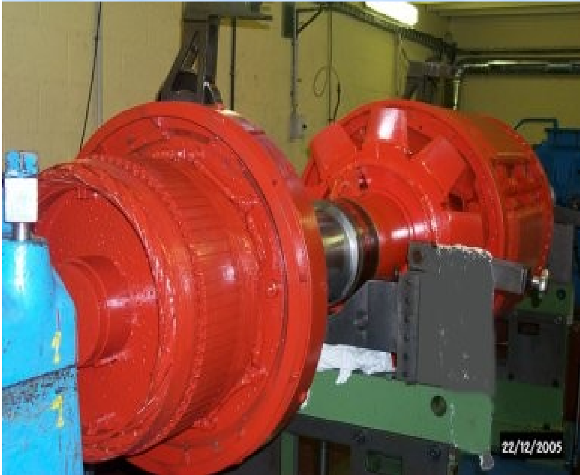
Rotor d'excitateur monté sur alternateur 1500 T/M en cours d'équilibrage
