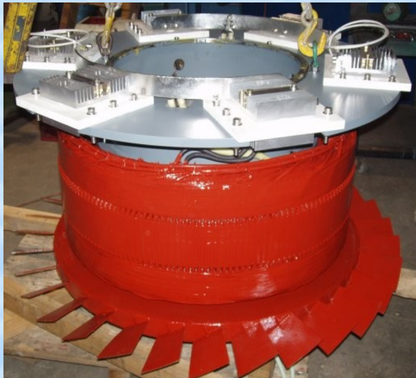
Rotor d'excitateur avec redresseur pour hydraulique
